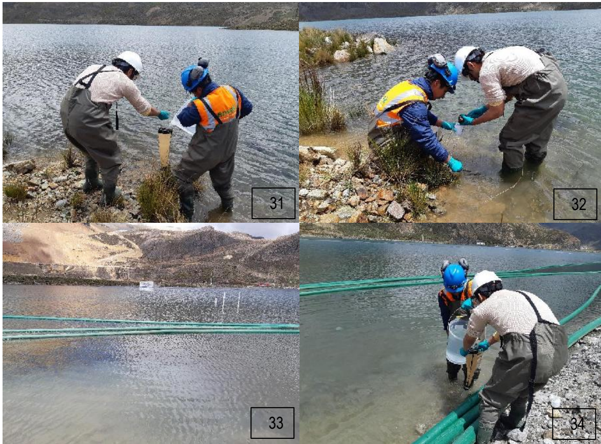
Foto 31.- Colecta de plancton mediante filtrado de agua superficial en la estación Hi-01 (Laguna Huacracocha).
